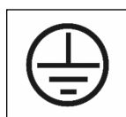
Вывод защитного заземления
