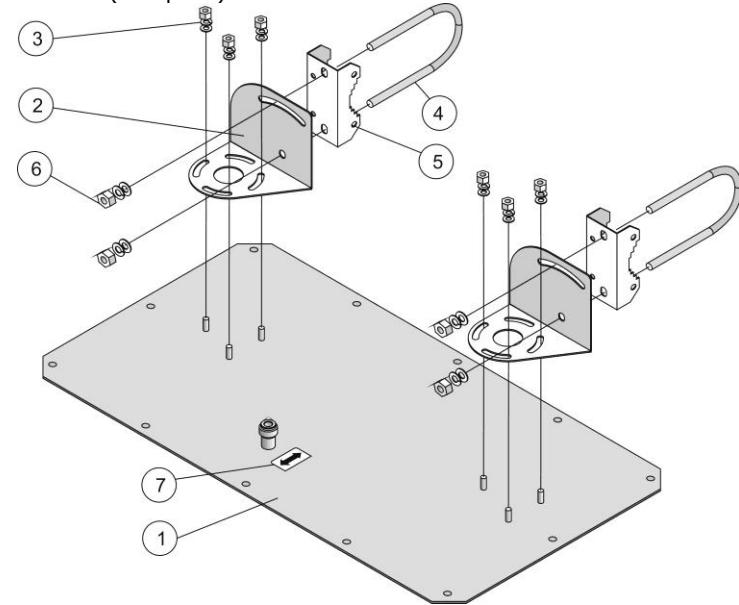
Рисунок 2. Сборка антенны на примере антенны CIFRA-12
