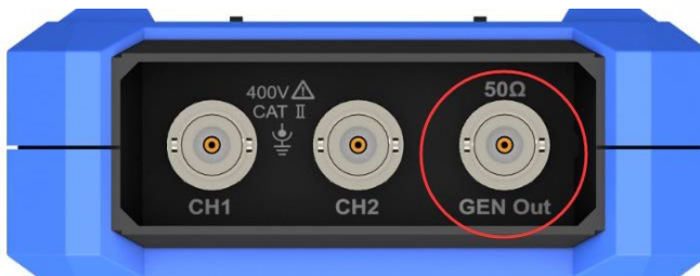
Рисунок 5.1. Выходной разъем генератора сигналов
