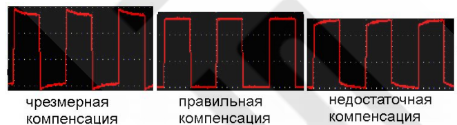
Рисунок 3.5. Варианты осциллограммы при компенсации щупа
